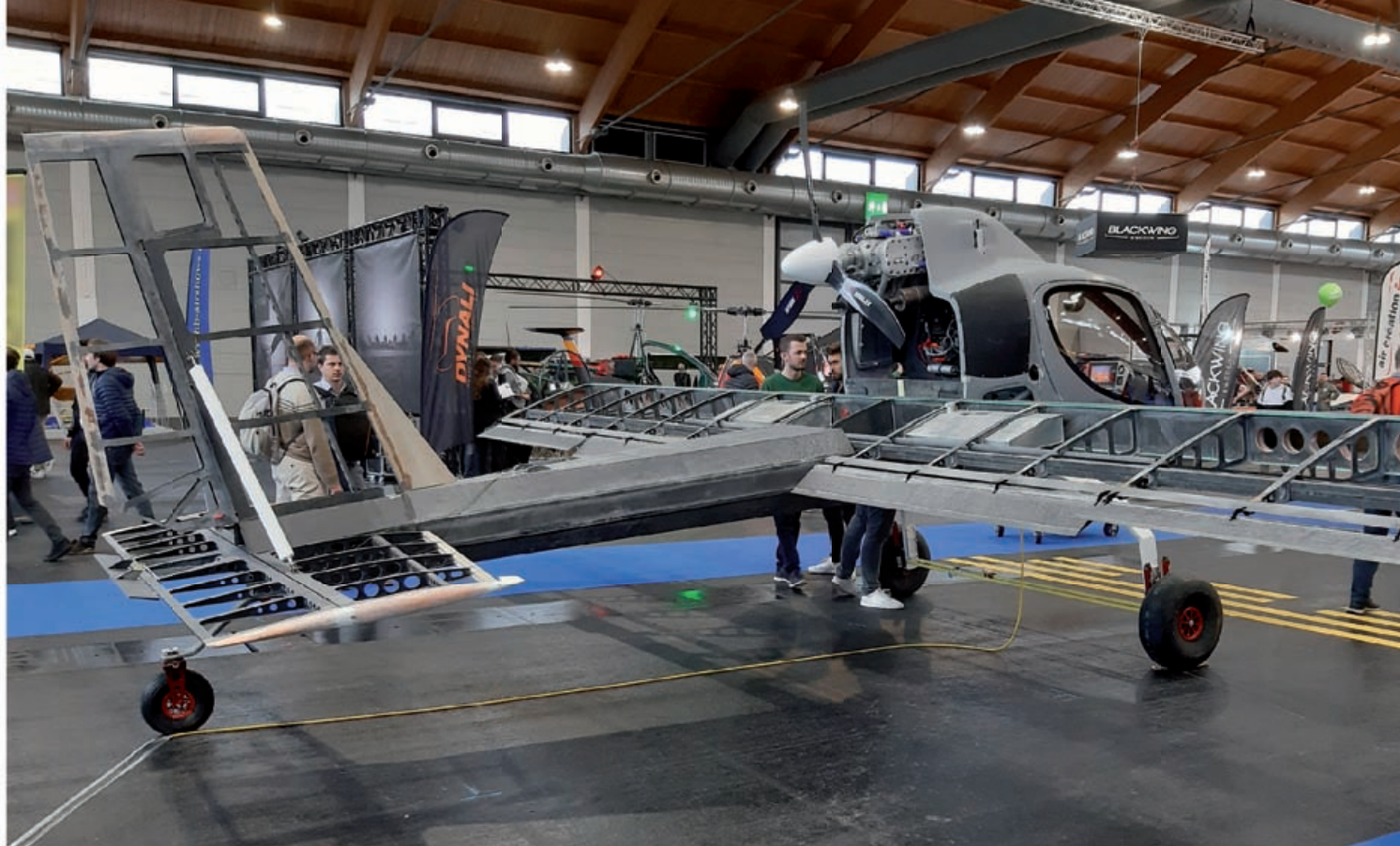
Der Rumpfausleger wirkt sehr massiv und trägt hier ein normales Leitwerk, könnte später aber mit einem V-Leitwerk versehen werden.
