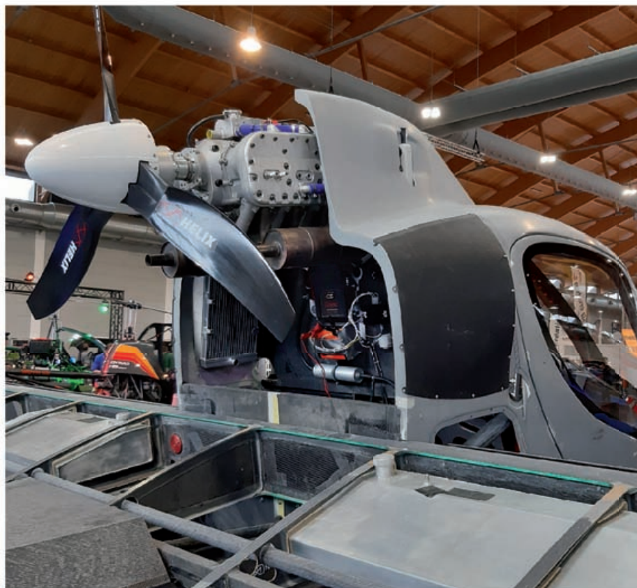
Der Motoreinbau des LF39 der Firma D-Motor mit dem Schubpropeller ist wartungsfreundlich gelöst. Einlässe für die Kühlluft befinden sich auf beiden Seiten des Motors und über der Kanzelverglasung.
