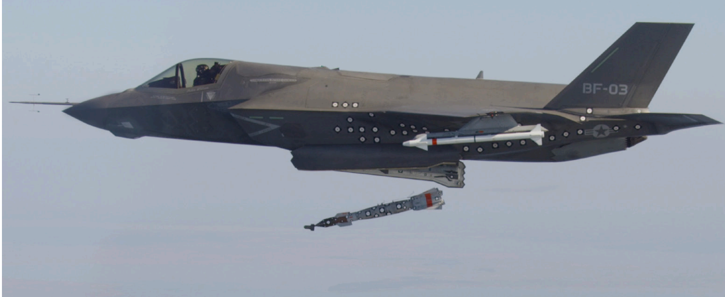
Ein Prototyp der F-35 wirft hier eine nachgesteuerte Präzisionsbombe aus dem Waffenschacht ab. Die Kombination von hochentwickelter Sensorik am Trägerflugzeug und sogenannter „intelligenter“ Bomben erhöht die Schlagkraft, es werden daher weniger Flugzeuge für die Zerstörung eines Zieles benötigt.
