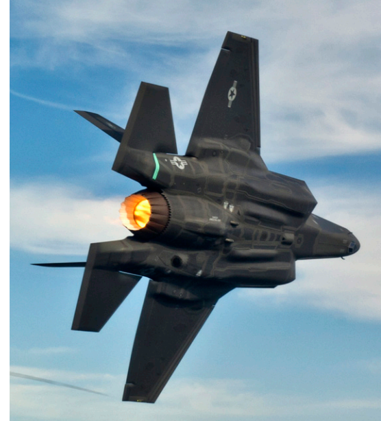
Im Vergleich zur F/A-18 kommt die F-35 mit einem Triebwerk aus.
