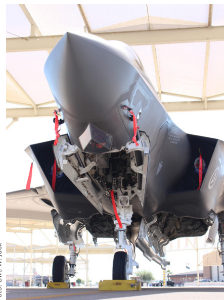
Unter dem Bug der Maschine befindet sich eine empfindliche Videokamera und ein Laser.
