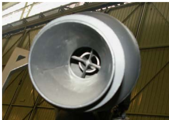
Links: Das geschnittene Triebwerk der Hs 293 zeigt rechts die Einspritzung gegen eine Prallschale und den Spiralgang zur Verlängerung des Mischungsweges.
