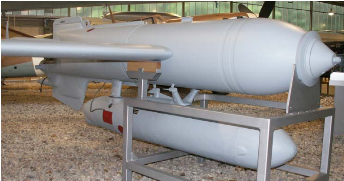
Der Anti-Schiffs-Flugkörper der Henschelwerke Hs 293 wurde durch ein untergehängtes kaltes Waltertriebwerk beschleunigt. Hier eine erhaltene Hs 293 in Berlin-Gatow.
