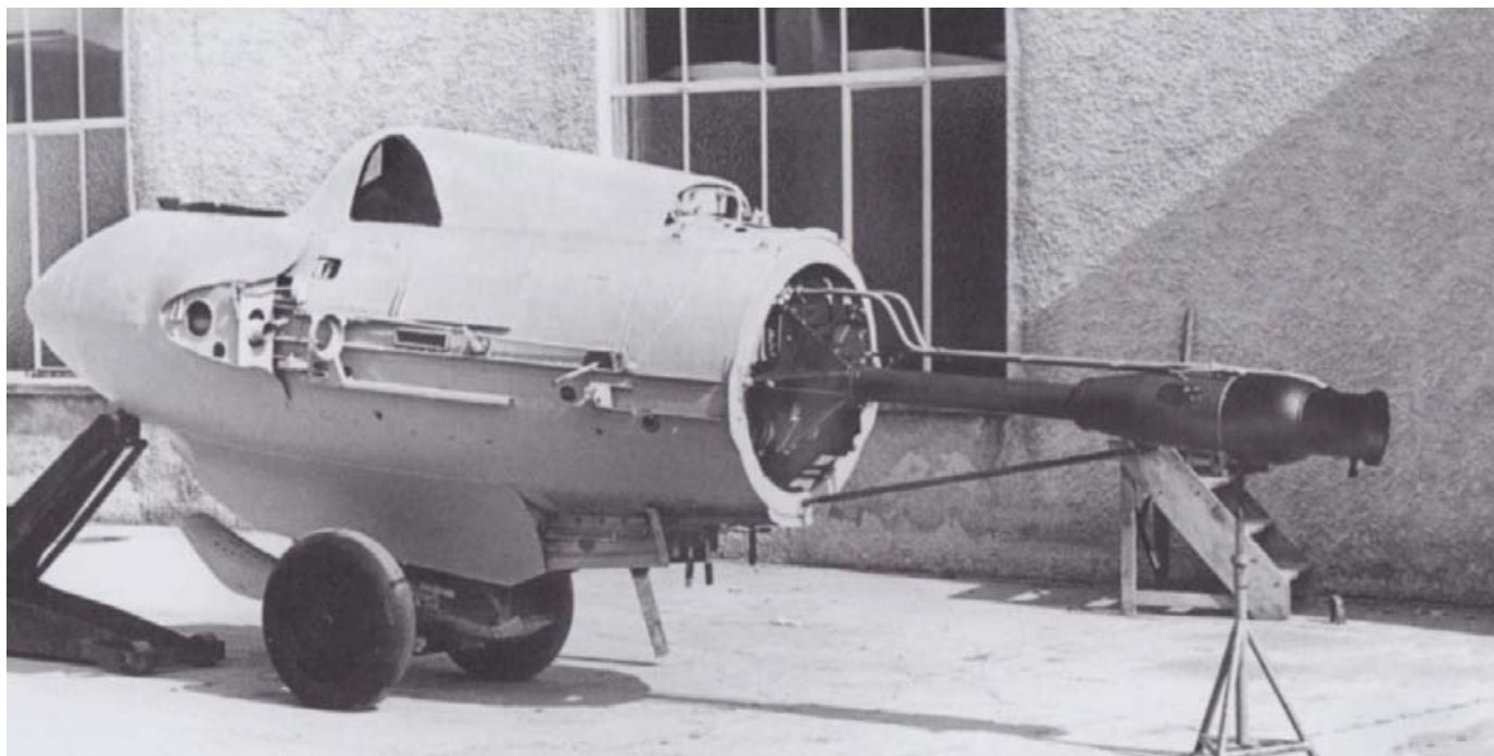
Zur Wartung des Triebwerks konnte das Rumpfhinterende der Me 163 abgezogen werden.
