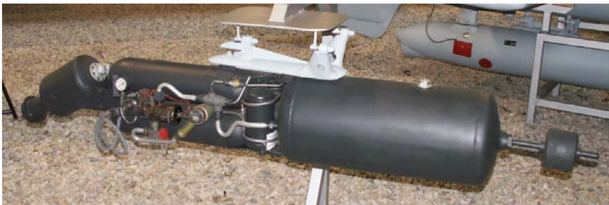
Unten: Der Antriebsblock der Hs 293 ohne Verkleidung. Das Triebwerk links ist so abginkelt, dass der Schub durch den Schwerpunkt des Flugkörpers geht. In der Mitte liegen zwei lange Pressluftbehälter mit dem kleinen Katalysatortank und rechts der Peroxidtank mit einem Gewicht zum Einstellen des Schwerpunktes.
